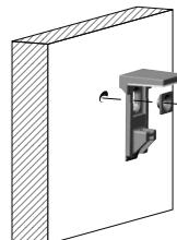
3. Fastlåsning av hyllan i hyllbäraren. Använd stjärnmejsel PZ2 (1) för att skruva fast. Lås fast enligt bild (2)
